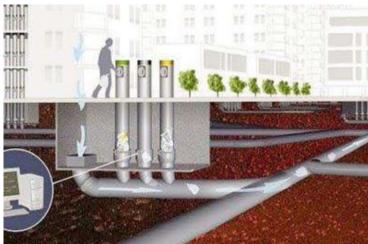
Figura 17. Recogida neumática de Residuos. (Fuente: Hammarby Sjostad, 2004)
